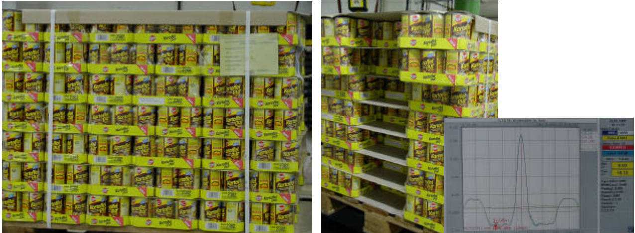
Abbildung 6: Ladeeinheitensicherung an der Ladeinheit "Kartoffel pur" mittels zweier Umreifungsbänder nach 4999 Schock 8g/10ms
