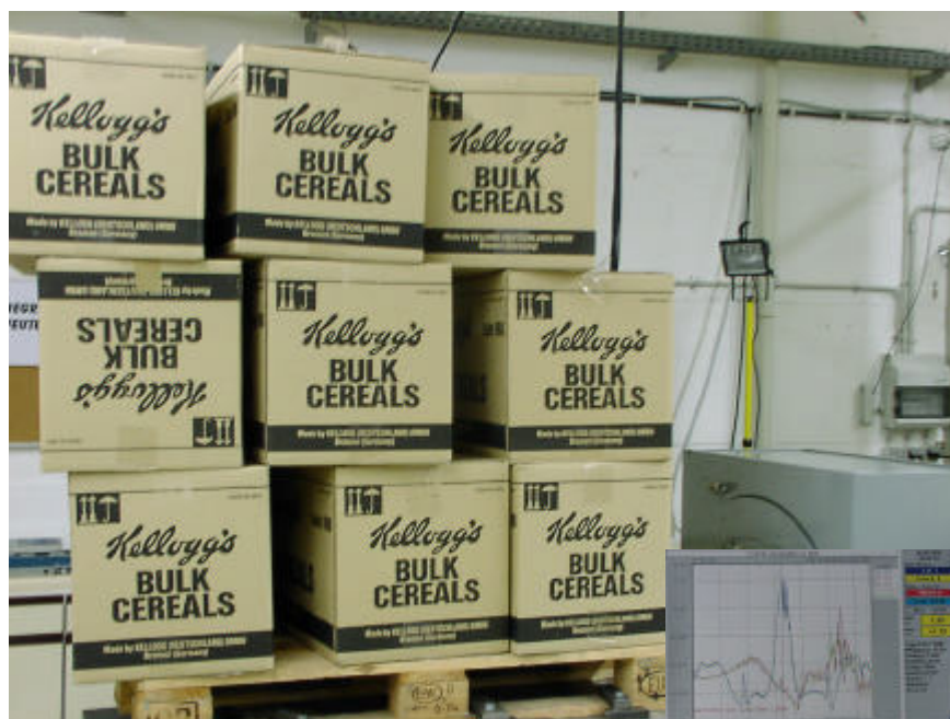
Abbildung 5: Verrutschte Ladeeinheit, ungesichert mit Frühstückscerealien nach den Prüfungen „Rütteln“, „Random-Vibration“ und „Schocken 1,5g/15ms“
