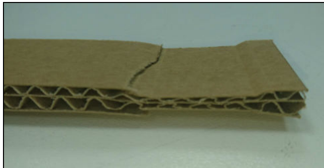
Abbildung 10: Schadensbild beim Zugversuch an Wellpappe
