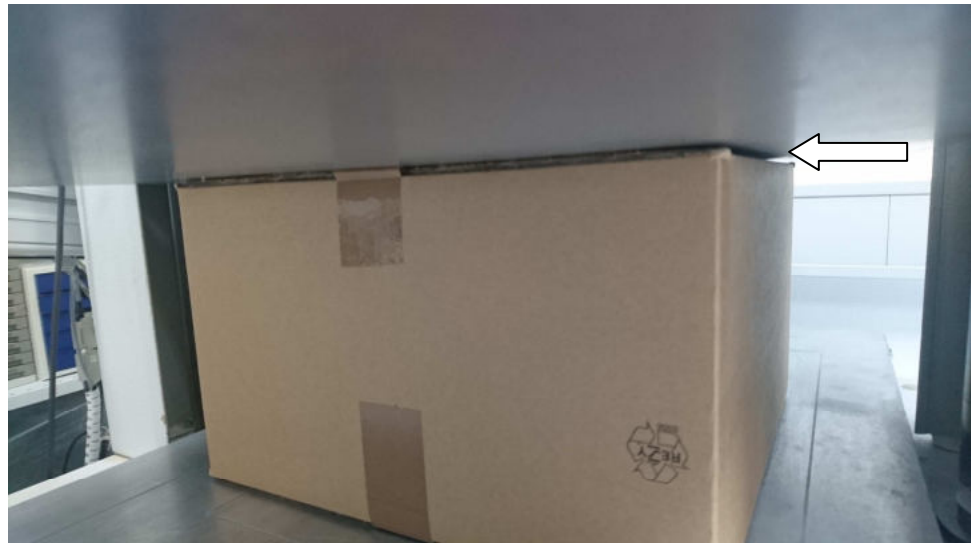
Abbildung 50: Freie Ecke (weißer Pfeil) ohne Tragwirkung zu Beginn eines BCT-Versuchs
