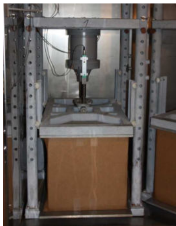
Abbildung 40: Versuchsaufbau zur BCT-Langzeituntersuchung von Packmitteln in einer Klimakammer mit durch Klebeband für alle Versuche standardisiert verschlossenen Öffnungen
